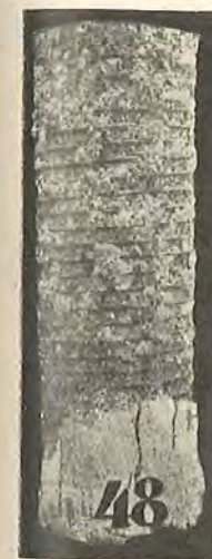
Fig. 104. Knust 8-kantet Prisme med cylindrisk Bevikling 5) .
