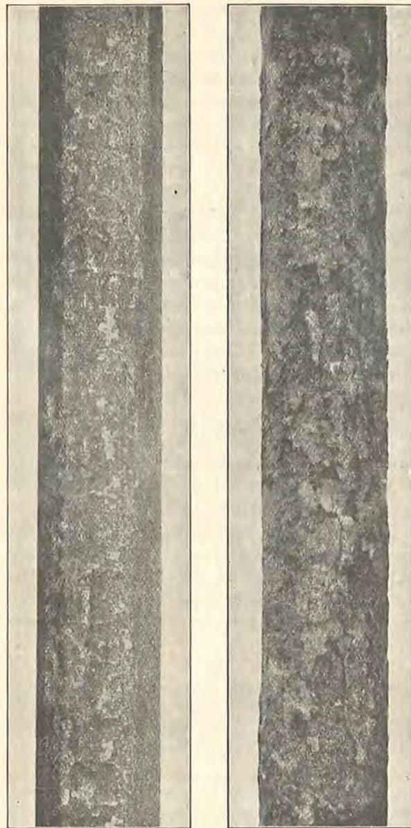
Fig. 11 1) . Rustfrit og stærkt rustent Rundjærn fra Bachs Adhæsiionsforsøg. Det første er i Indleveringstilstanden, det andet har ligget ude fra April til August.
