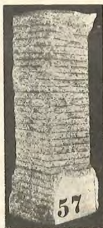
Fig. 92. Knust Prisme med Bevikling.
